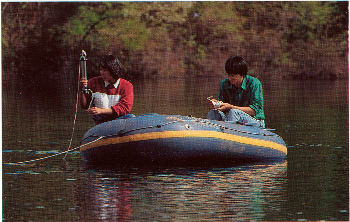
水質はゴムボートに乗って沼の中央で観測した。水をくんでいるのは採水器で、この中に温度計がセットされている。
